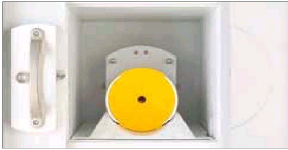
Вигляд радіаційного відсіку. Ємність, що обертається — з'ємна, що дозволяє обробку у звичайному режимі. Розмір: 314x316x500мм.
